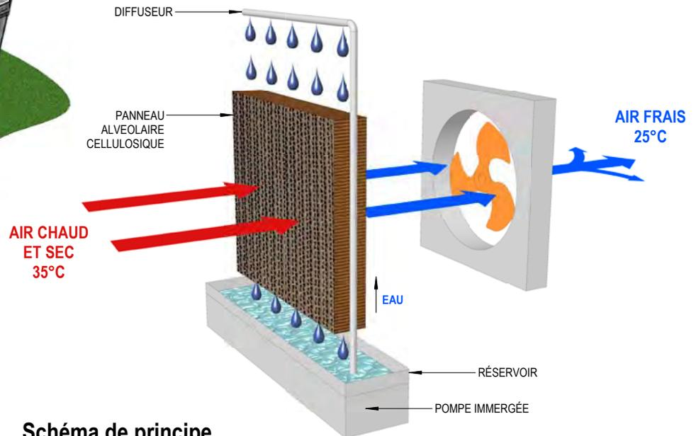
Schéma de principe
