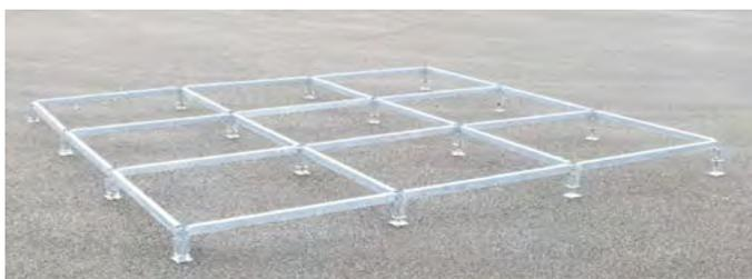
Plancher modulable à l'infini en longueur et en largeur, réglable en hauteur de 190 mm à 240 mm, jusqu'à 540 mm avec calage bois. Composé de seulement 3 types de pièces standards : pied, longeron et plaque de plancher.
