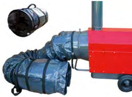
Gaine de raccordement de l'appareil de chauffage vers la tente. Confection en tissu enduit classé feu M1, avec raidisseur hélicoïdal et sac de rangement intégré avec poignée
